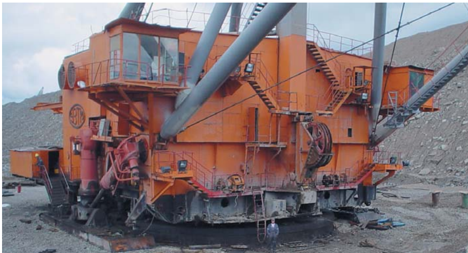
Nur im “Watschelgang” kann sich der über 80 m hohe Schürfkübelbagger auf seiner Schreiteinheit bewegen.
